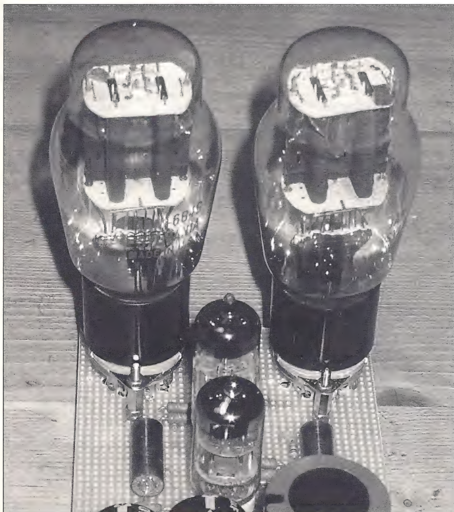
de eindversterker opgebouwd op een stukje universeel printplaat.
